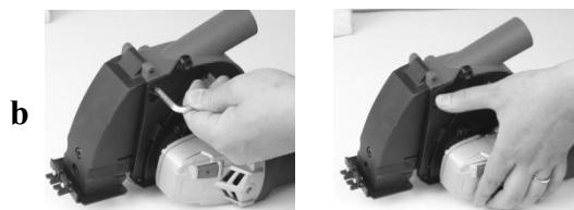
3) Upevnite vnútornú prírubu a potom vložte prvý kotúč. (viď obrázok c)
