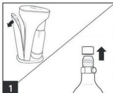
Zložte zadný kryt výrobníka a ochrannú plombu ventilu, tak ako je uvedené na obrázku. Zložte ochranný kryt bombičky a gumovú zátku na ventile CO<sub>2</sub>.
