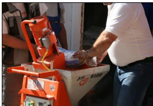
Obrázek 12 Vsyávání suché maltové směsi do zásobníku
